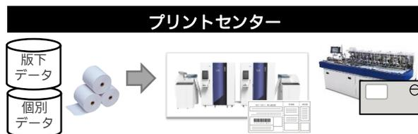
白紙のロール紙に「システムデータ印字」と「専用紙作成」を同時に行う。※必要な分だけ印刷
